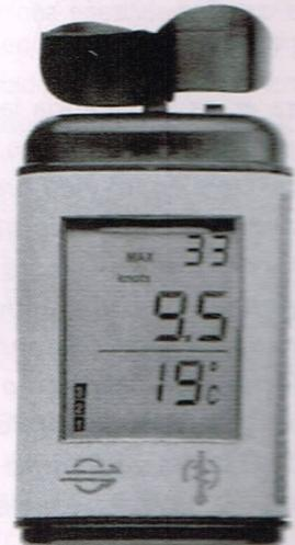
*Estación meteorológica SKYWACH METEOS, con lectura de datos de velocidad y temperatura instantáneas, medias y máximas*
